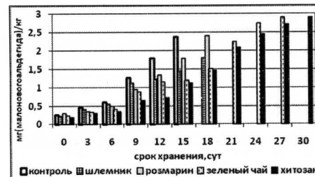
Рис. 13. Изменения тиобарбитурового числа жира в процессе холодильного хранения полуфабриката рыбных колбас при 4°C.
