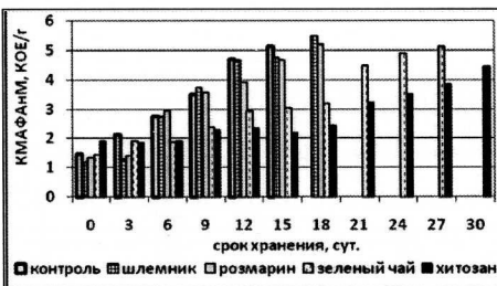
Рис. 5. Изменения КМАФАМ (N/10 4 ) в процессе холодильного хранения полуфабриката рыбных колбас при 4°C.
