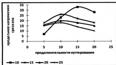
Рис. 17. Изменение предельного напряжения среза рыбной колбасы в зависимости от продолжительности куттерования и количества добавляемой воды, %
